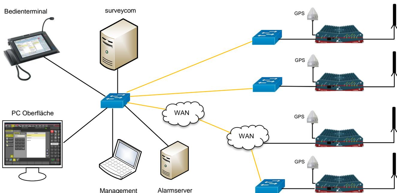
Mit surveycom stehen die verschiedensten Möglichkeiten und Schnittstellen in der Analogen und Digitalen (DMR) Funktechnik zur Verfügung. surveycom verwaltet die Peripherien sowie die angemeldeten Hand- und Mobilfunkgeräte. Die Bedienstellen von Telematix ermöglichen eine übersichtliche und einfache Bedienung durch den Mitarbeiter in der Leitstelle. Die integrierte Sprachaufzeichnung erfasst sämtliche Analog- und DMR-Kommunikation innerhalb der Funknetze.
